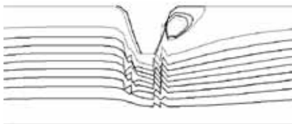
Рисунок 2.5. Поле скоростей при высоте 0,4R и ширине 0,3R
